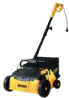
Spazzolatrice Brush Machine J-Comber-302-E Motore elettrico Electrical Engine: 230 V - 50 Hz Potenza - Power: 300 W Larghezza lavoro Working Width: 40 cm
