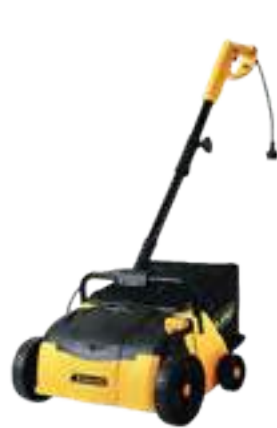
Spazzolatrice Brush Machine J-Comber-302-E Motore elettrico Electrical Engine: 230 V - 50 Hz Potenza - Power: 300 W Larghezza lavoro Working Width: 40 cm
